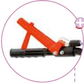
“GEARSTOP” stellt den Motor nicht ab sondern blockiert das Getriebe und die Zapfwelle, falls der Lenkholmgriff losgelassen wird.
