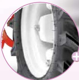
Die Radaussenbreite und die Spurweite sind einstellbar. Die Einstellungen dienen dazu, die Maschine an Spezialkulturen anzupassen
