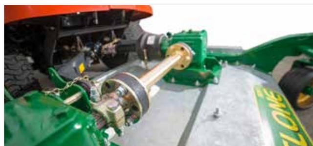
Transmission par cardan et renvois d'angle robustes
