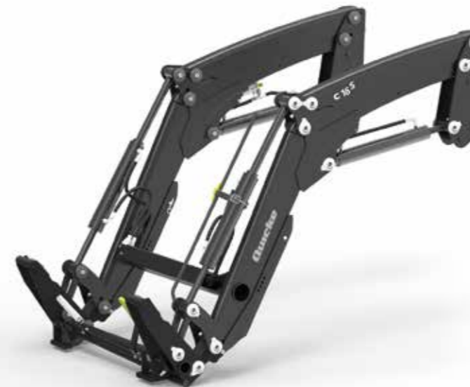
Ladermodel mit mechanischer Parallelführung
